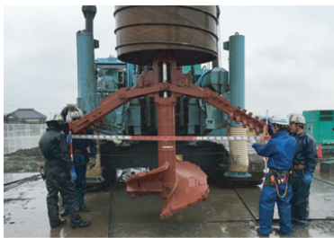
写真2 油圧式拡翼先端ビット
